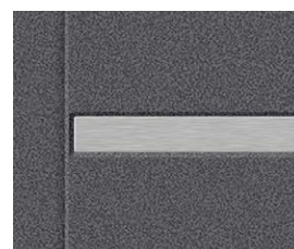
Oboustranné prolisy o šířce 25 mm s intarzií s povrchovou úpravou INOX nebo lakovanou načerno. Intarzií je možné montovat jednostranně nebo oboustranně. Vkládá se do prolisu a je v jedné rovině s křídlem (STAMP) nebo nalepená na ploché dveřní křídlo (LABEL).
