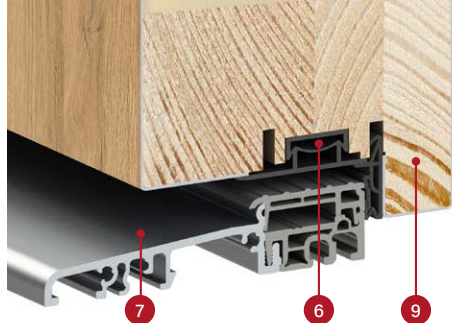
prierez krídla THERMO HOT 88 s alebo bez padacieho tesnenia, hliníkový prah
